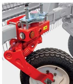
I robusti **ammortizzatori** delle ruote piroettanti assorbono gli urti sui terreni sconnessi e proteggono la struttura.
