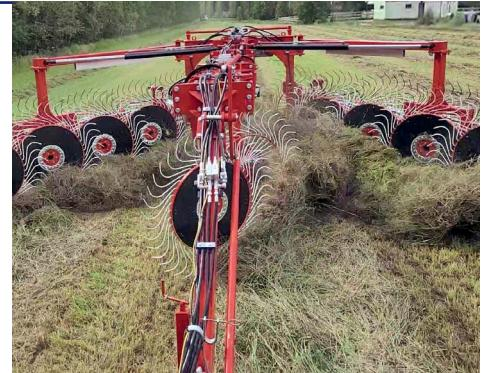
**Des soleils centraux** (relevés et abaissés hydrauliquement) permettent de déplacer le fourrage disposé dans l'allée centrale.
