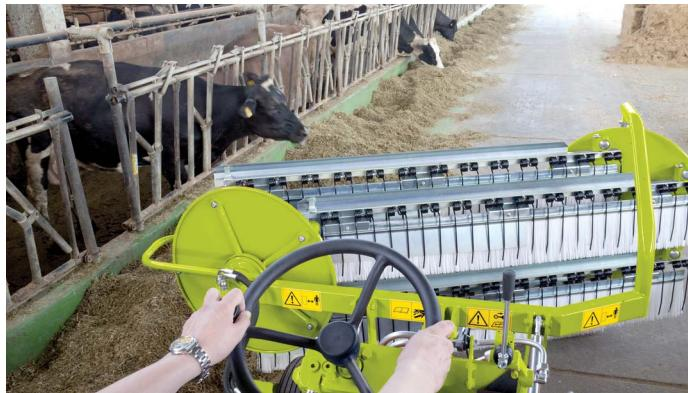
Il posto di guida, centrale e rialzato, consente all'operatore una visione completa della corsia di alimentazione, permettendo un intervento immediato in caso di necessità. Dal posto di guida si comanda comodamente l'intera macchina: l'avanzamento, il sollevamento, l'abbassamento e l'azionamento delle spazzole, l'accensione e lo spegnimento, il controllo delle spie di sicurezza.
