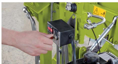
La motospazzola è equipaggiata con un motore Diesel monocilindrico con contralbero di bilanciamento delle forze d'inerzia secondarie, avviamento elettrico e, per i casi di emergenza, avviamento con autoavvolgente. È anche dotata di una valvola di elettro-stop per spegnere il motore girando la chiave nel cruscotto.
