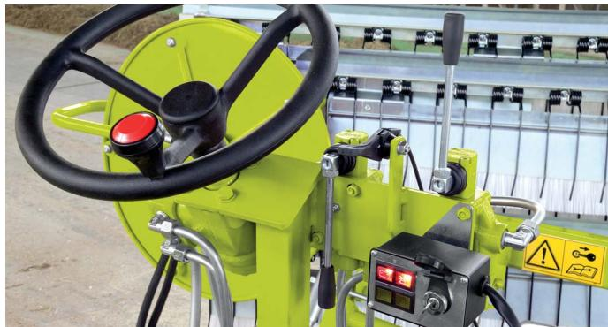
Le poste de conduite, central et relevé, permet à l'opérateur un contrôle général de l'allée d'alimentation et donc d'intervenir immédiatement en cas de nécessité. Il est possible de commander sans difficulté l'ensemble de la machine depuis le poste de conduite: avancement, soulèvement, descente et actionnement des brosses, démarrage et arrêt, contrôle des témoins de sécurité.
