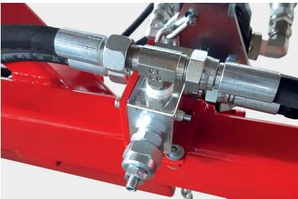
Gli aspi sono azionati idraulicamente (da una pompa indipendente) e ruotano ad una velocità ottimale, costante e indipendente dall'avanzamento. Questo permette di scegliere la velocità di lavoro più adatta in base al tipo di prodotto da ranghinare. In caso di urti accidentali gli aspi si bloccano grazie all'intervento di una valvola di sicurezza opportunamente tarata.
