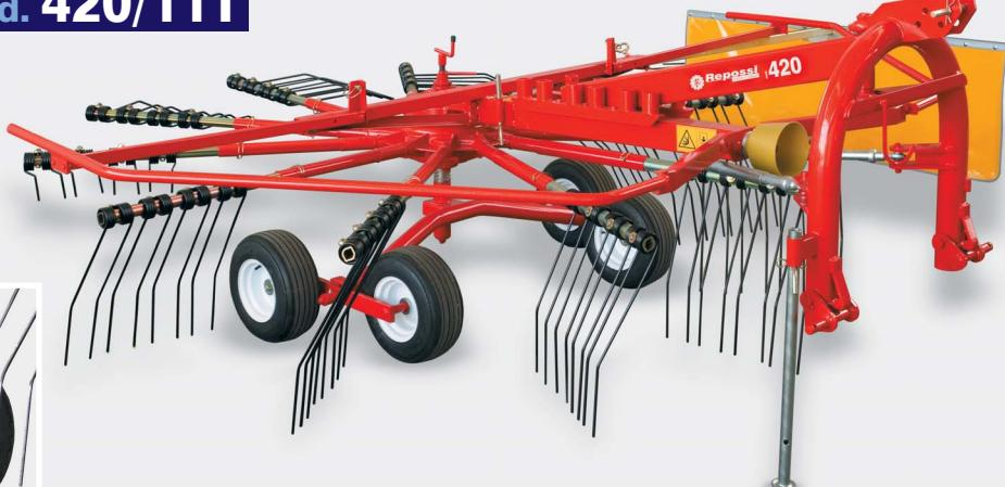
I giroandanatori Repossi mod. 350/9T, 420/11T e 460/12T con il loro telaio sterzante e con 4 ruote montate su carrelli tandem in posizione molto vicina ai denti, permettono di avere un piano di lavoro perfetto e di ottenere un'andana soffice e pulita anche su terreni sconnessi. I gruppi rotanti sono sigillati in bagno d'olio a garanzia di elevate prestazioni e di massima affidabilità.
