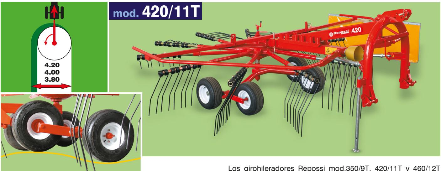
I giroandanatori Repossi mod. 350/9T, 420/11T e 460/12T con il loro telaio sterzante e con 4 ruote montate su carrelli tandem in posizione molto vicina ai denti, permettono di avere un piano di lavoro perfetto e di ottenere un'andana soffice e pulita anche su terreni sconnessi. I gruppi rotativi sono sigillati in bagno d'olio a garanzia di elevate prestazioni e di massima affidabilità.
