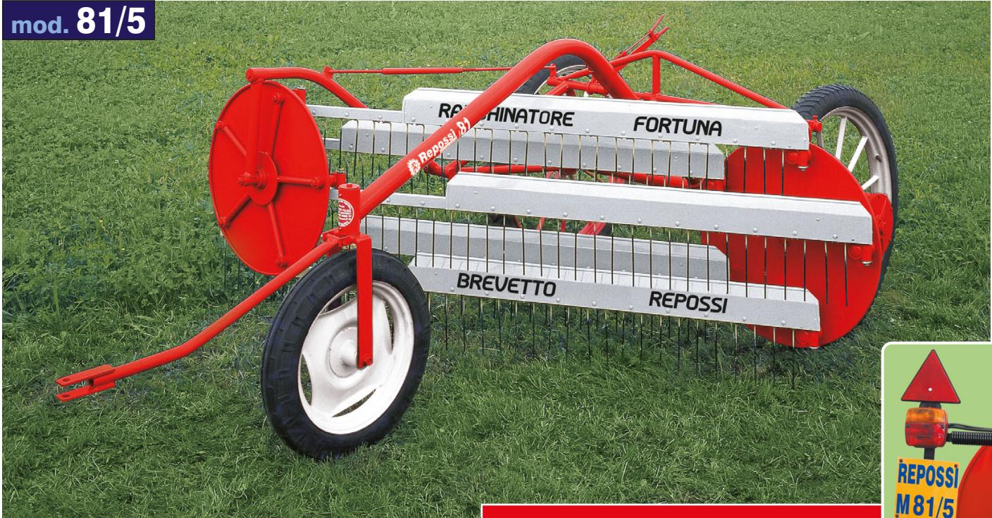
I mod. 81/5 e 68/4 vengono utilizzati su terreni pianegianti e nelle marcite. Il grande diametro delle ruote posteriori consente di superare facilmente ogni ostacolo. La distanza tra i pettini e il suolo viene regolata millimetricamente con un semplice e comodo sistema a vite.
