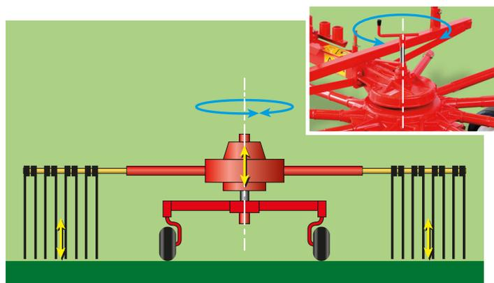
Equipaggiato di ruota anteriore tastatrice regolabile in altezza e da snodo speciale si ottiene un piano di lavoro perfetto e indipendente dal trattore.
