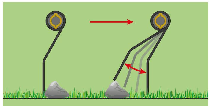
Die Doppelzinken aus patentiertem Federstahl garantieren hervorragende Qualität und minimale Abnutzung. Ihre exklusive Form erlaubt der Spirale die aufkommenden Kräfte uniform zu verteilen. Die doppelte Inklination erlaubt eine elastische Deformation beim Auftreten von Steinen und verhindert somit deren Aufnahme
