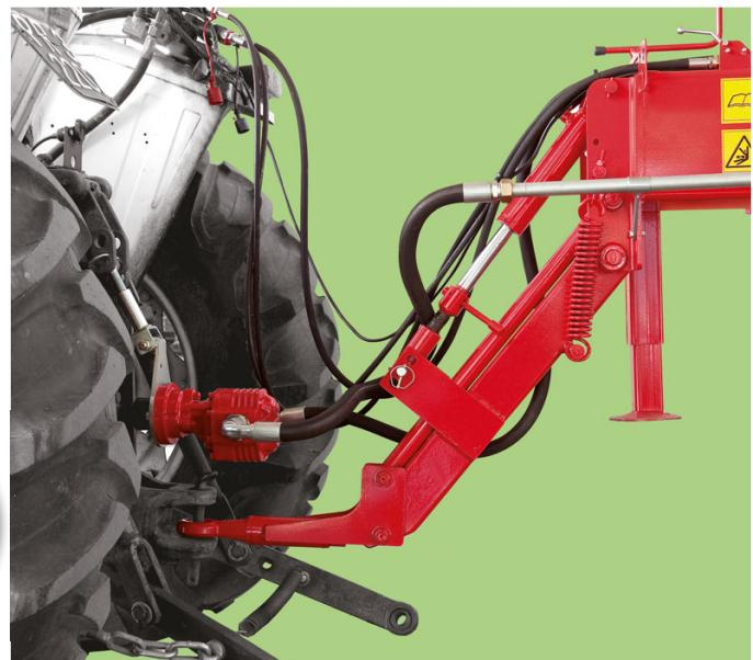
Ogni rotore è regolabile in altezza con un semplice e preciso sistema a vite e si solleva idraulicamente sia per le operazioni di fine campagna che per il trasporto su strada (luce da terra tra 0.50 e 1.00 m) così da evitare lo strisciamento laterale degli pneumatici. La struttura a parallelogrammo del timone di traino lo mantiene sempre orizzontale e non genera interferenze con il trattore.
