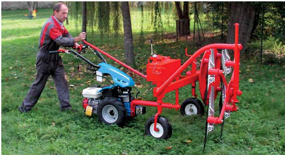
Il ranghinatore è equipaggiato di due ruote pneumatiche regolabili in altezza a vite che consentono di ottenere una perfetta regolazione della macchina rispetto al terreno e da una barra di guida che permette di utilizzare questo ranghinatore anche collegato a motofalciatrici o motocoltivatori senza differenziale.
