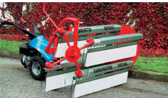
Equipaggiato di spazzole accessorie, il ranghinatore può essere utilizzato per la pulizia di strade e piazzali oppure per rimescolare e avvicinare il foraggio nelle corsie di alimentazione delle stalle.
