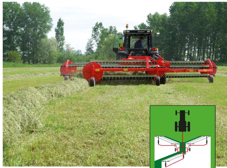
Il comando elettroidraulico di nuova concezione permette di azionare il ranghinatore e di cambiarne la configurazione di lavoro tramite un semplice comando a distanza posizionato nella cabina del trattore.
