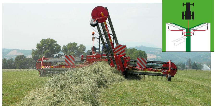
Beim Betrieb mit Zentralschwade ermöglicht die Maschine auch große Futtermengen (erste Schnitte) zu schwaden, eine uniforme und fertige Schwade formierend, bereit zur Aufnahme durch die Presse oder kleine Schwaden vor den Nachtstunden zu formieren.
