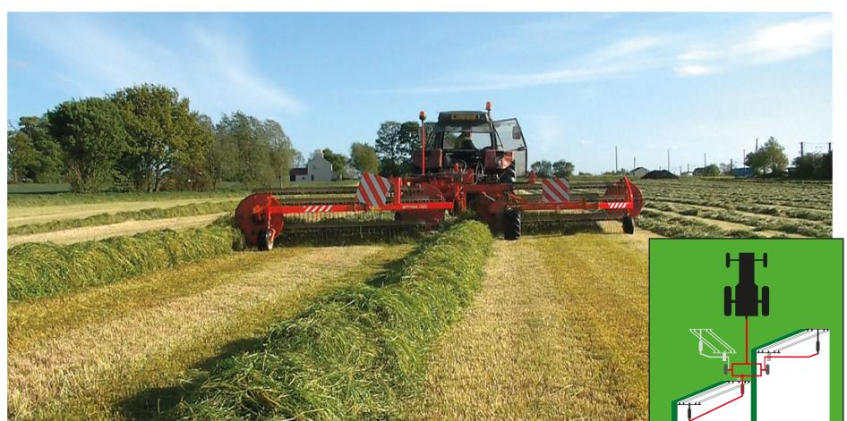
Beim Betrieb mit doppelter Seitenschwade realisiert der Schwader zwei wenig voluminöse Schwaden, die Trocknung des Futters während des Tages erleichtern. In der Funktion Zentralschwade vereinigt die Maschine darauffolgend die beiden Schwaden vor der Nacht.
