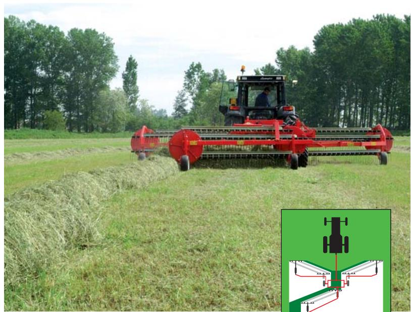
Il comando elettroidraulico di nuova concezione permette di azionare il ranghinatore e di cambiare la configurazione di lavoro tramite un semplice comando a distanza posizionato nella cabina del trattore.
