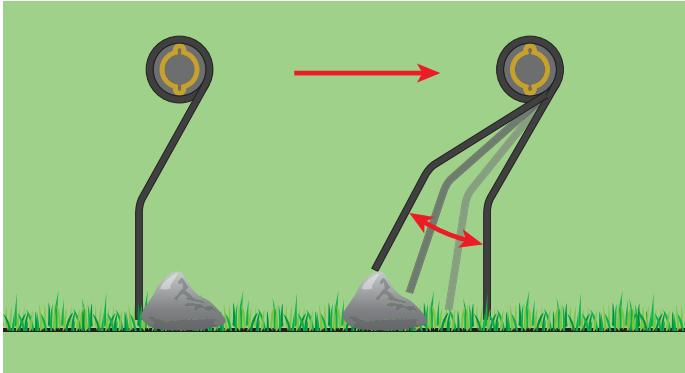
Los dientes dobles son realizados en acero patentado con garantía de elevada calidad y máxima durabilidad. Su forma exclusiva permite a la espira de trabajar de manera tal de obtener una distribución uniforme de los esfuerzos. La doble inclinación les permite de deformar elásticamente cuando encuentran piedras evitando así la recogida de las mismas.
