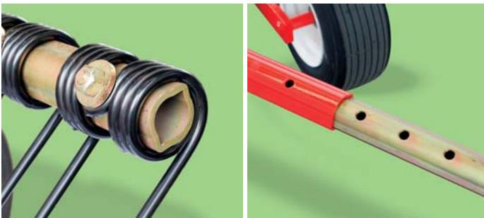
I denti doppi sono realizzati in acciaio patentato a garanzia di elevata qualità e di massima durata. La loro forma esclusiva permette alla spira di lavorare in modo da ottenere una distribuzione uniforme degli sforzi. La doppia inclinazione permette loro di deformarsi elasticamente quando incontrano dei sassi così da evitarne la raccolta.
