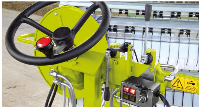
Il posto di guida, centrale e rialzato, consente all'operatore una visione completa della corsia di alimentazione, permettendo un intervento immediato in caso di necessità. Dal posto di guida si comanda comodamente l'intera macchina: l'avanzamento, il sollevamento, l'abbassamento e l'azionamento delle spazzole, l'accensione e lo spegnimento, il controllo delle spie di sicurezza.
